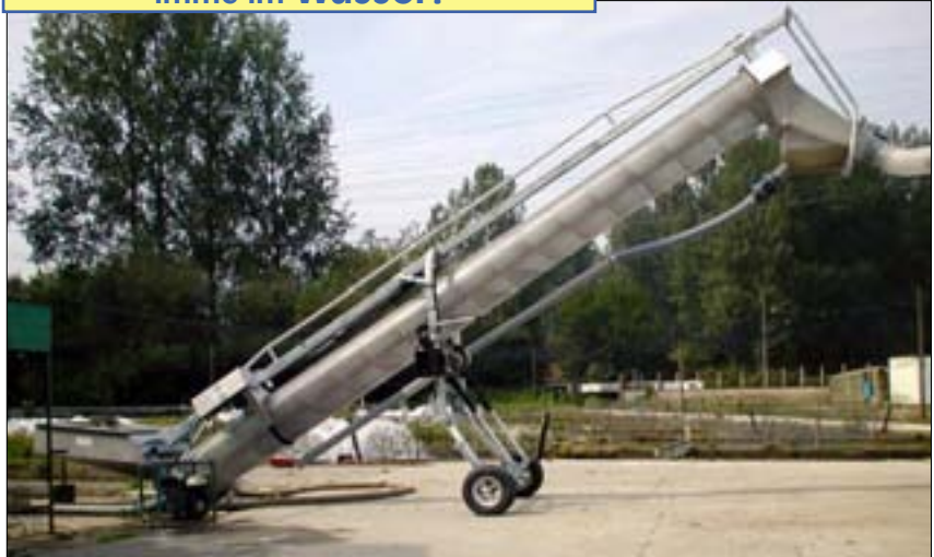
Modell 85 Schnecke Ø450mm Länge 5m - Option EPHP.
