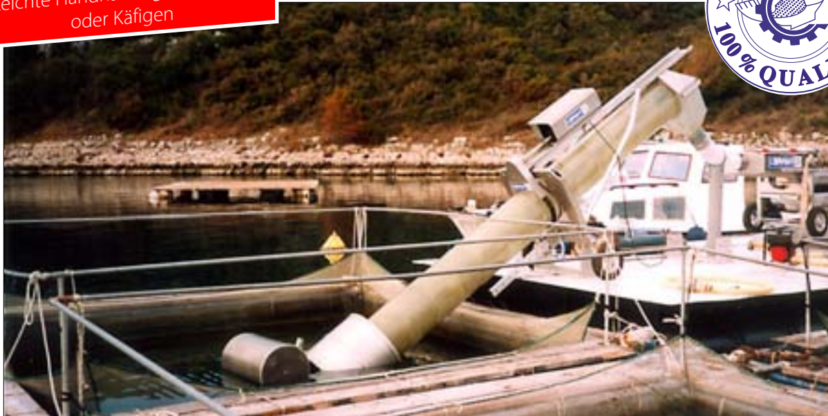
Förderer der Serie 77 ALU bei der Beschickung eines Trichters HELIOS 30S mit Barschen und Doraden auf einer Küstenbarke
